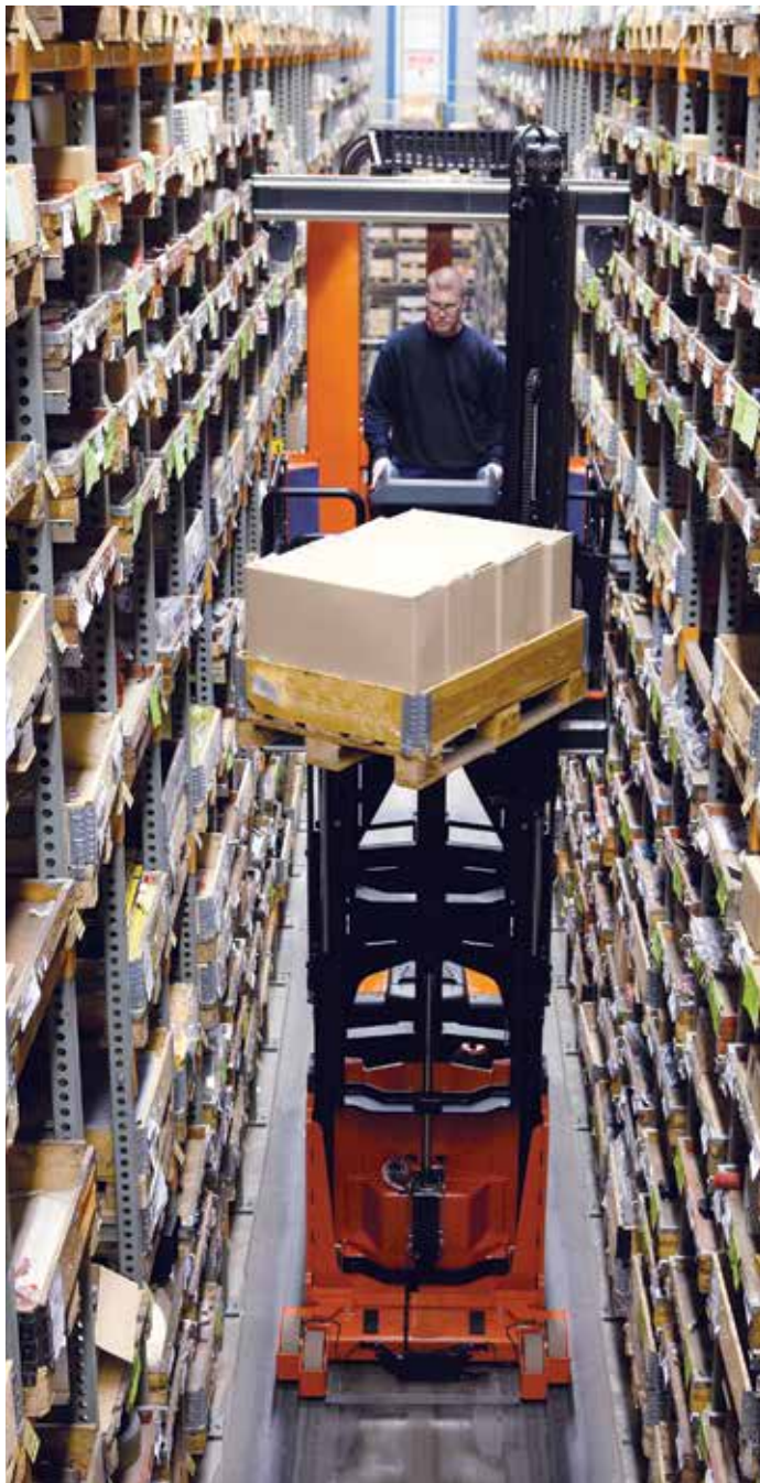
Door het BT Advanced Lifting System van de A-serie is er minder batterijvermogen nodig om de cabine en lading te heffen, zodat de batterij in een tweeploegendienst slechts één keer hoeft te worden geladen
