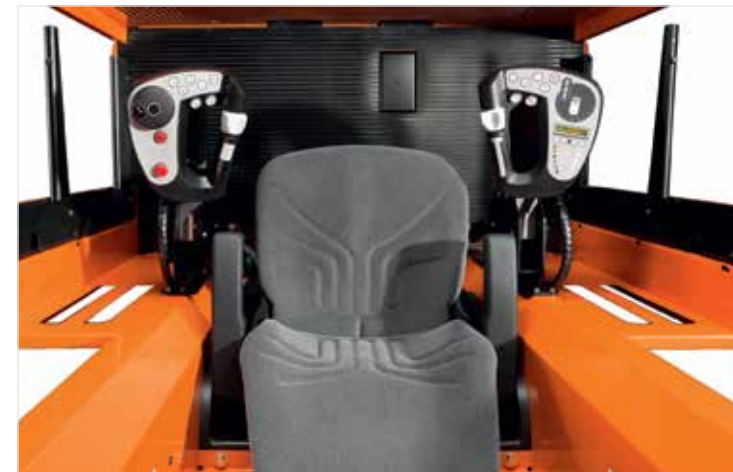
Door het gesplitste bedieningspaneel is de pallet goed bereikbaar voor orderverzameling
