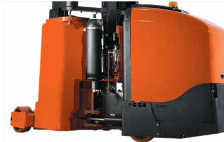
Door het BT Advanced Lifting System van de A-serie is er minder batterijvermogen nodig om de cabine en lading te heffen, zodat de batterij in een tweeploegendienst slechts één keer hoeft te worden geladen
