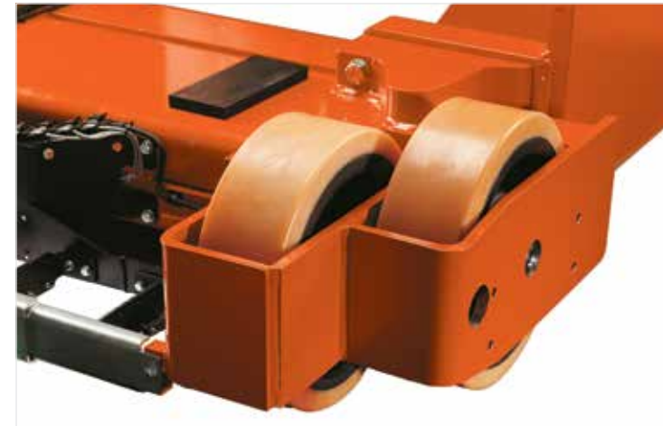
Verspringende steunpootwielen verhogen de stabiliteit en vermindert de vloerbelasting
